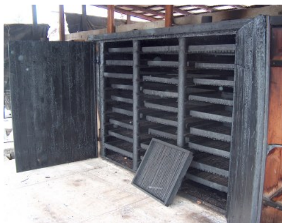
Fot. 2. Otwarta susznia. Wyciągnięta jedna laska.
